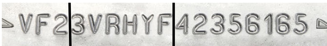
FIGURE 1 – Un exemple de VIN sur le châssis d'une voiture, séparé en trois parties : le WMI, le VDS, et le VIS.
