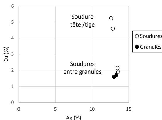
Fig. 11 Microanalyses par EDX des soudures et zones attenantes sur la tige zoomorphe.
