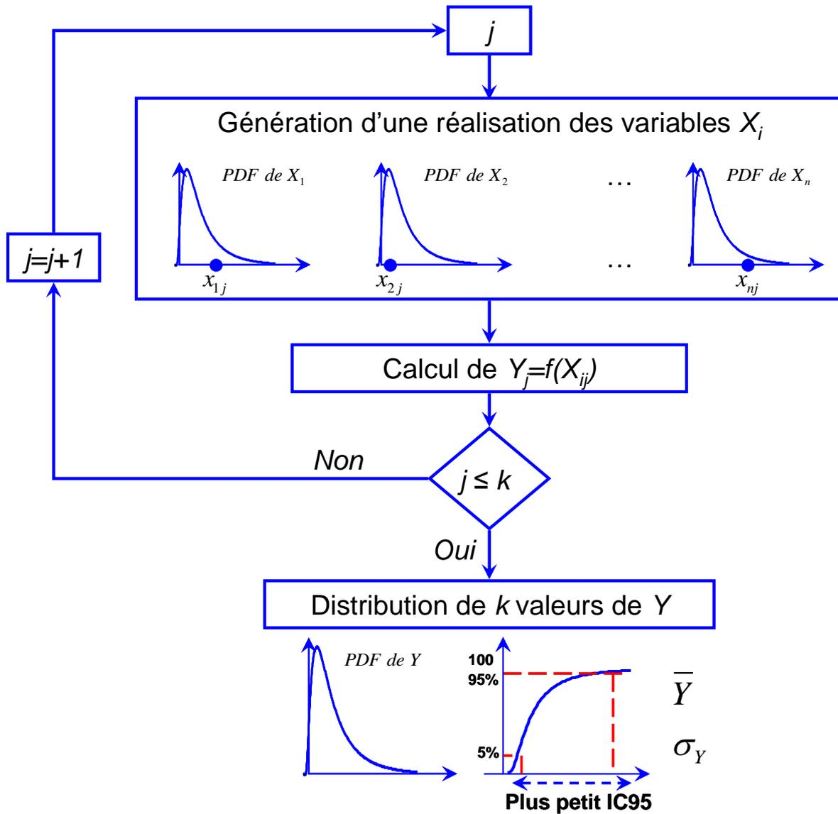
Figure 14 : Procédure de simulations de Monte Carlo
