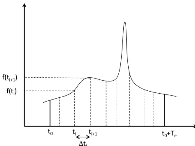
Figure 10 : Discrétisation d'une grandeur en fonction du temps
