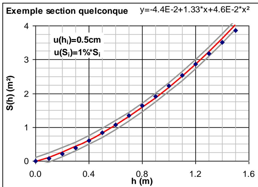
**Figure 9: Exemple d'une régression polynômiale d'ordre 2. Les deux courbes grises matérialisent l'intervalle de confiance à 95% pour  $u(h_i)=0,5$  cm et  $u(S_i)=0,01S_i$ .**
