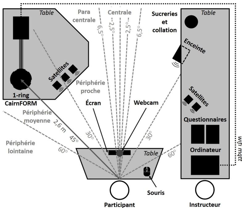
Pour déclencher le mouvement de l'anneau à distance, un serveur MQTT Mosquitto (Light, 2017) est installé sur le Raspberry Pi 3 de l'anneau qui est également configuré pour être un point d'accès wifi (Hotspot). L'ordinateur utilisé pour l'expérimentation est connecté en wifi au Raspberry Pi 3. En utilisant un client MQTT, l'ordinateur envoie un message au Raspberry Pi 3 qui déclenche le mouvement de l'anneau correspondant au message reçu.
