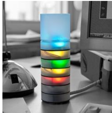
Figure 16. StaTube, une interface cylindrique, notifiée par changement de lumière (Hausen et al., 2012).
