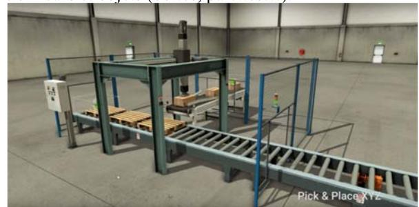
fig 4 : Système « Pick and Place » de FACTORY I/O
