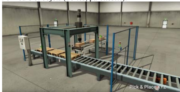
fig 4 : Système « Pick and Place » de FACTORY I/O
