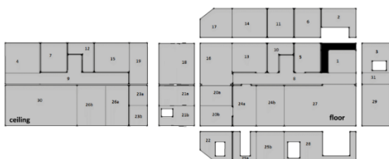
Fig. 4. Plan de discrétisation de l'enveloppe
