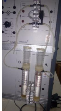
Figure 8 : Electrolyseur et pile à combustible
