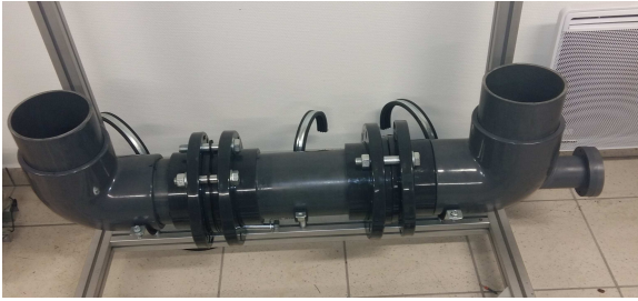
Fig. 12. Base des colonnes des pistons liquides de la partie détente.
