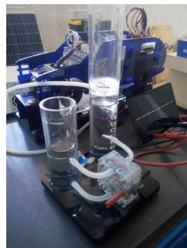
Figure 14 : Station de production d'hydrogène
