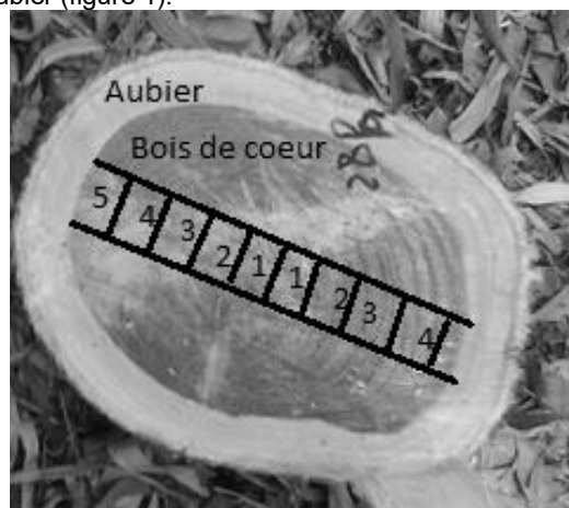
Fig. 1.: Image montrant le découpage des échantillons et leur numérotation de la moelle vers l'aubier
