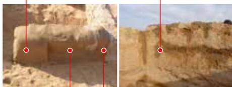
Test 2: enduit sacrificiel fin (3-5 mm)
