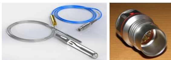
Figure 12 : Un Collectron (à gauche) et un connecteur male verre/métal (à droite).
