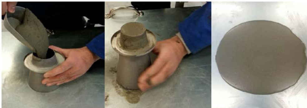
Fig. 2. Steps of mini slump flow test.
