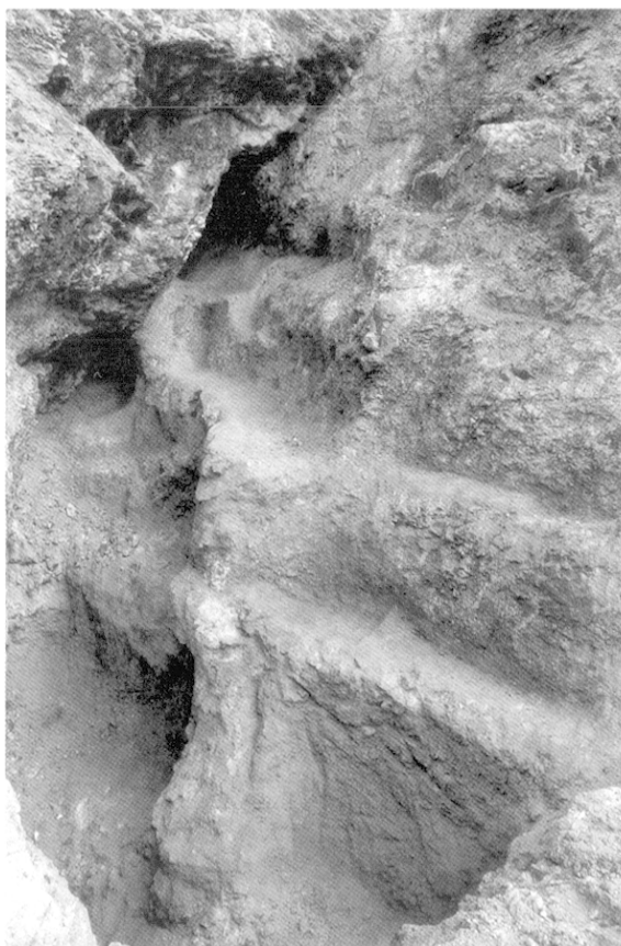
Fig. 12 – Galeries et gradins permettant la circulation et l'avancement des chantiers miniers dans la mine-puits 1000 (cliché : W. O'YL, INRAP).
