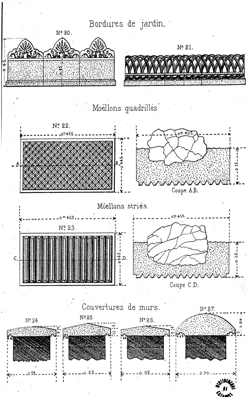
**fig. 48 Bordures, moëllons et murets en ciment moulé**
