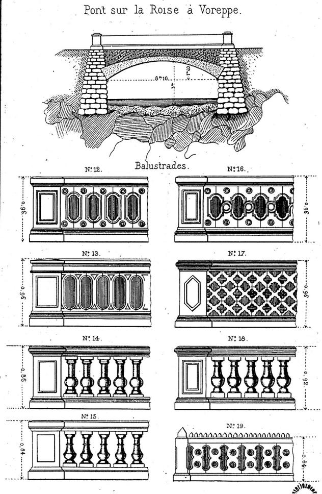
fig. 46 Balustrades en ciment moulé
