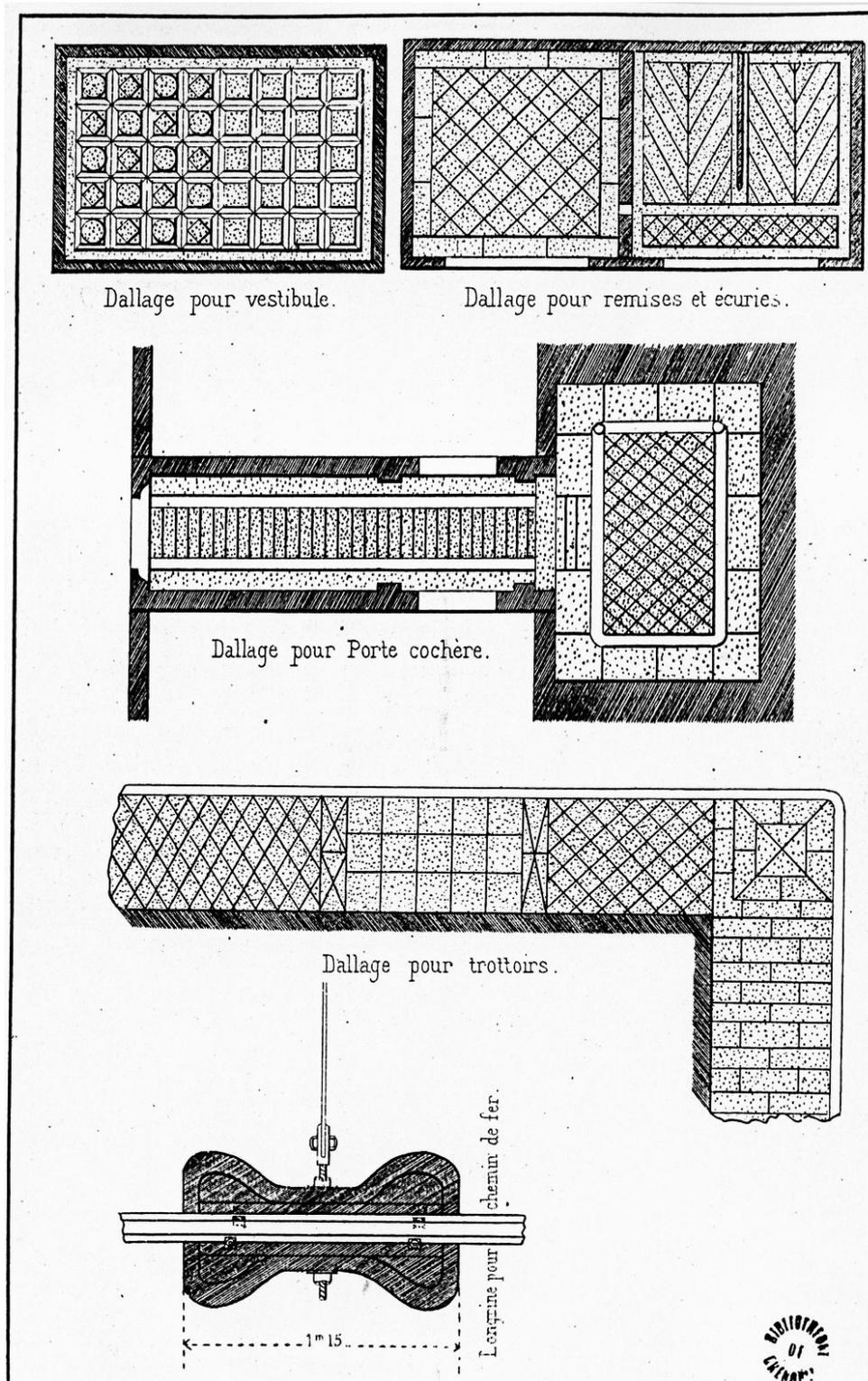
fig. 51 Trottoirs en béton
