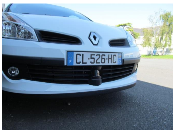
Figure 3 : Instrumentation du VOICIE avec les lidars réalisée par le Véhipole et la DTerOuest (Cere-ma) : a) LiDAR avant ; b) LiDAR arrière placé sur un porte-vélo.
