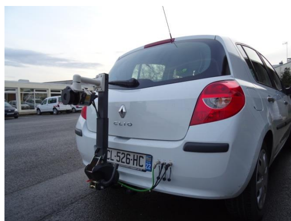
Figure 3 : Instrumentation du VOICIE avec les lidars réalisée par le Véhipole et la DTerOuest (Cere-ma) : a) LiDAR avant ; b) LiDAR arrière placé sur un porte-vélo.
