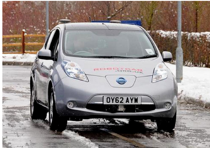
Figure 16 : Robocar de l'Université d'Oxford - le LiDAR quatre nappes est installé sous la plaque d'immatriculation. (Source : Université d'Oxford).
