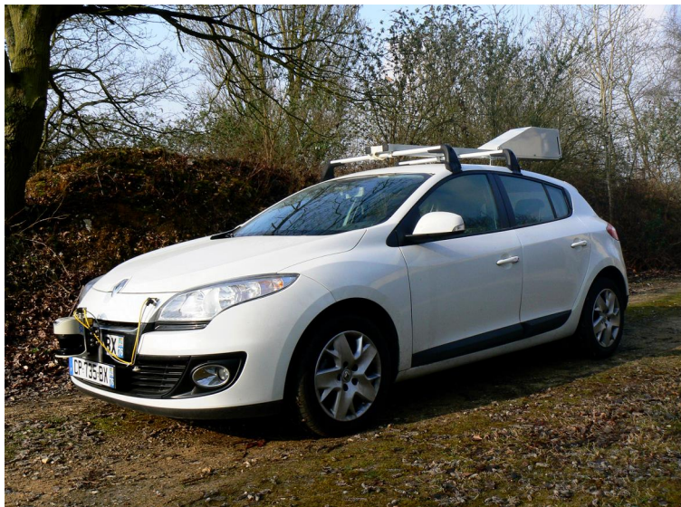
Figure 1 : Instrumentation de véhicule DTerNC non conforme – LiDAR arrière intégré dans le coffre de toit.
