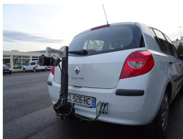
Figure 3 : Instrumentation du VOICIE avec les lidars réalisée par le Véhipole et la DTerOuest (Cere-ma) : a) LiDAR avant ; b) LiDAR arrière placé sur un porte-vélo.
