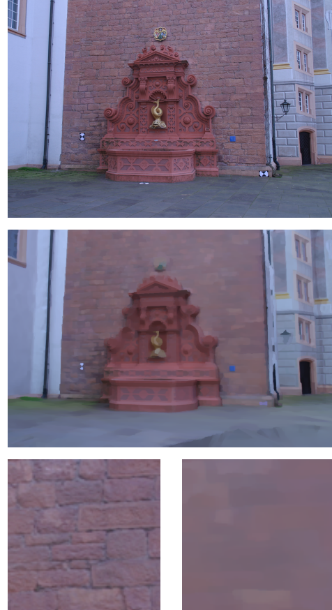
FIGURE 9 – Première ligne : une vue réelle (parmi 25) de l’objet fountain-P11 [14]. Deuxième ligne : albédo coloré estimé par l’approche proposée. La géométrie et les paramètres des caméras ont été estimés par SfM/MVS à partir des 25 images. Seules 8 images ont été fournies à notre algorithme. Troisième ligne : zooms de ces deux images, sur une même partie du mur de brique à l’arrière de la fontaine.
