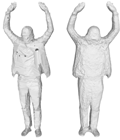
FIGURE 4 – (gauche) Enveloppe visuelle (54/68 caméras) et (droite) notre volume de confiance \alpha = 10 , \beta = 10 .
