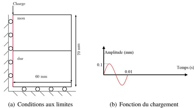
FIGURE 1 – Modèle de plaque plane proposé
