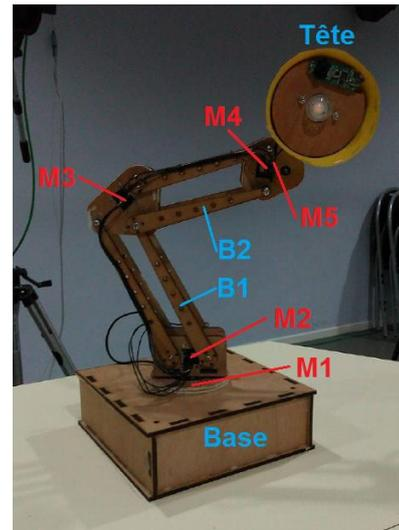
Figure 2 : Pièces et moteurs de la lampe
