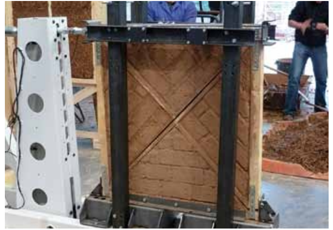
Des essais ont été réalisés à plusieurs échelles et avec différents remplissages (à gauche en pierres maçonnées à la terre, à droite en adobes) à l'aide de deux murs à réaction.
