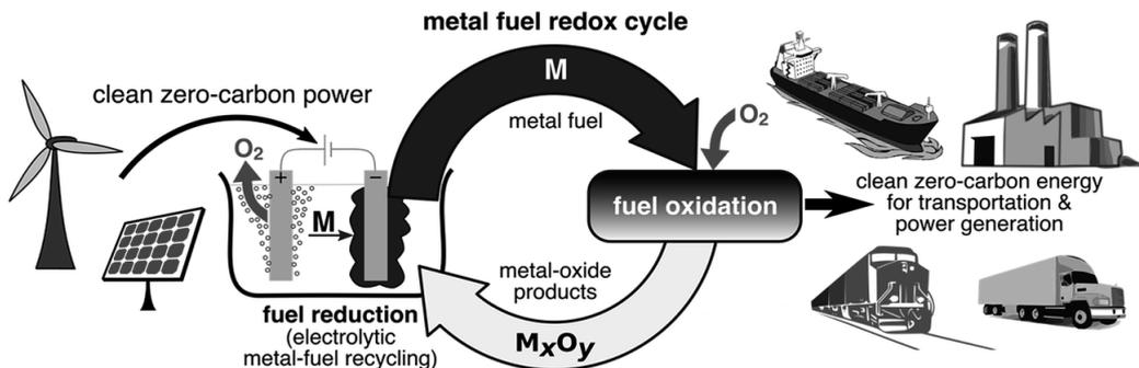
Figure 2: Représentation schématique du concept de vecteur énergétique métallique [5]
