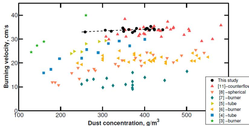
Figure 6: Comparaison des vitesses de flamme pour des richesses d'aluminium entre 0.8 à 1.5
