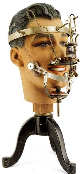
**CASQUE UTILISÉ POUR MENER DES RECHERCHES EN PHONÉTIQUE CONÇU PAR LE PHONIAATRE HENDRIK ZWAARDEMAKER (1857-1930). CET APPAREIL PERMETTAIT D'ENREGISTRER LE MOUVEMENT DE LA LÈVRE SUPÉRIEURE ET DE LA MÂCHOIRE INFÉRIEURE DURANT UN DISCOURS.**
