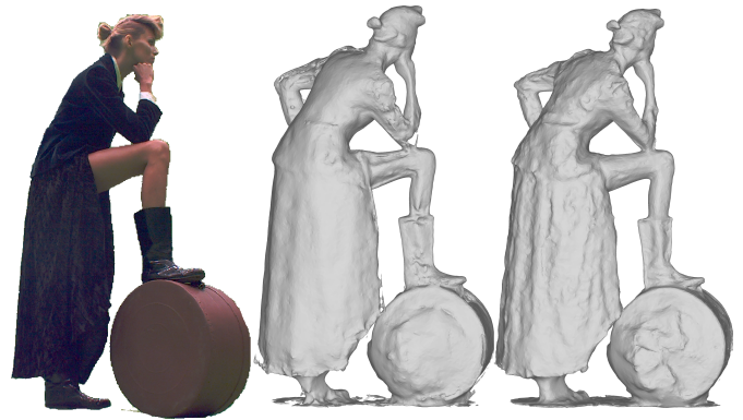
FIGURE 1 – Scène dynamique complexe, capturée avec un système multi-caméras passif. ( gauche ) une image d’entrée, ( centre ) reconstruction obtenue avec des descripteurs d’image classiques [21], ( droite ) solution proposée. Notre résultat confirme les améliorations que peuvent apporter une approche d’apprentissage, globalement plus robuste dans les zones bruitées ou de faible contraste, telles que les plis de la robe, le bras ou la jambe du modèle.
