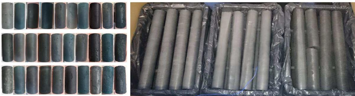
**Figure 2.** Gauche : Etat des éprouvettes après chaque cycle d'exposition gel-dégel (haut : eau, milieu eau gypseuse, bas : eau acide). Droite : Illustration de la conservation des carottes immergées dans les bacs placés dans les boîtes thermo-régulées lors d'un essai en condition isotherme.
