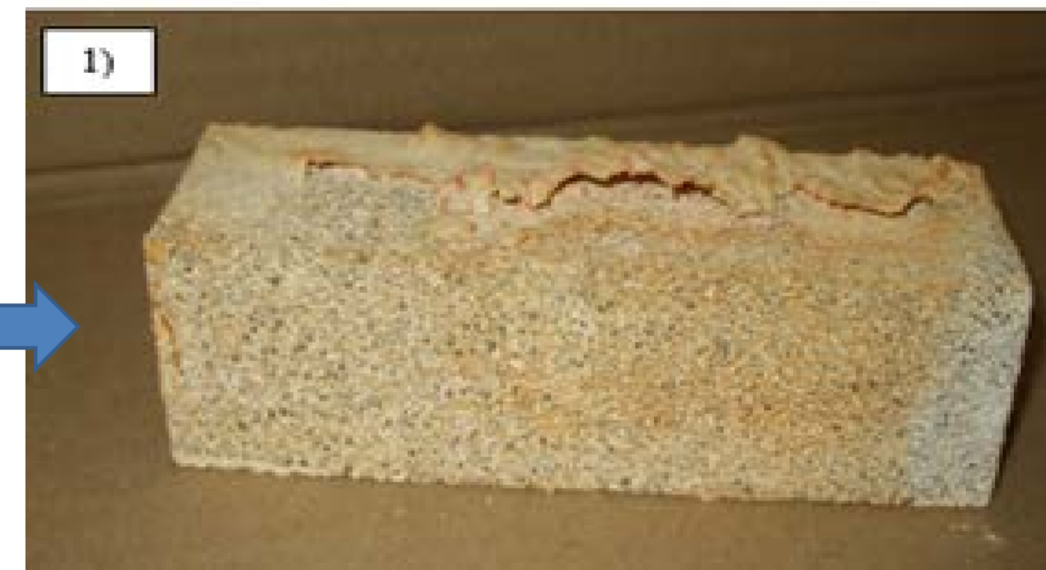
Éprouvettes conservées dans : 1) acide sulfurique, 2) sulfate d'ammonium.
