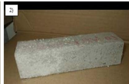
Éprouvettes conservées dans : 1) acide sulfurique, 2) sulfate d'ammonium.
