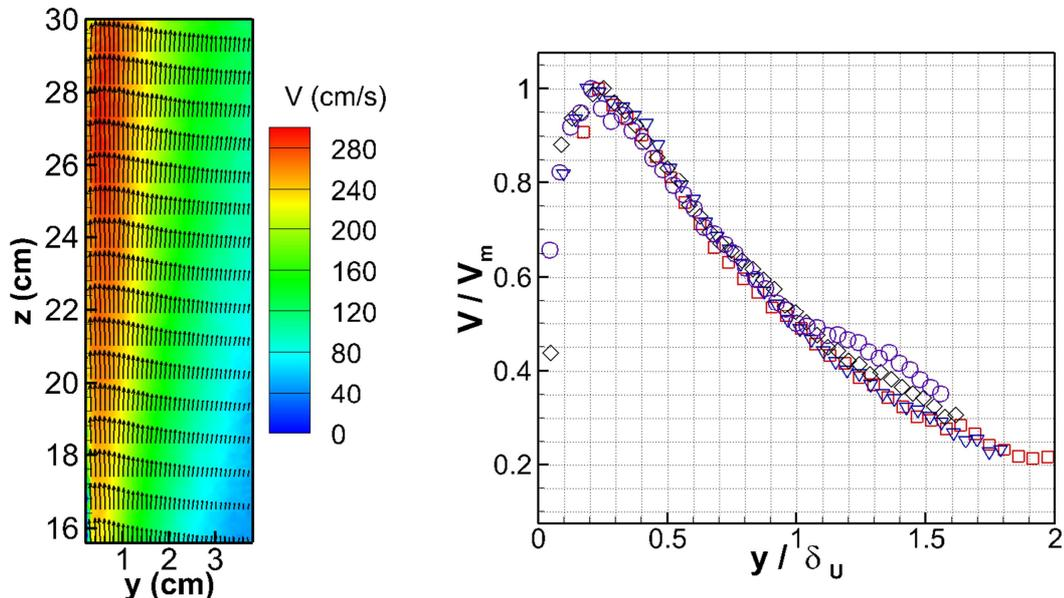
Figure 7 : a) (Gauche) Champ moyen de vitesse, b) (Droite) Profil transversal de la vitesse verticale moyenne (Grandeurs normalisés) à 4 hauteurs dans la flamme :  $z = 16$  cm (carrés),  $z = 20$  cm (triangles),  $z = 25$  cm (diamants) et  $z = 27,8$  cm (cercles).
