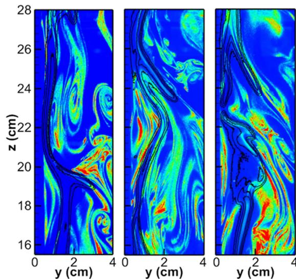
Figure 5 : Image PIV (couleur) et LII (contour) simultanés.
