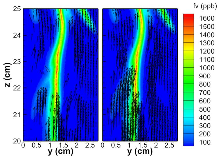
Figure 6 : Champ de vitesse et champ de fraction volumique (couleur) simultanés : (Gauche) sans prétraitement, (Droite) avec un prétraitement éliminant le signal de diffusion des suies.
