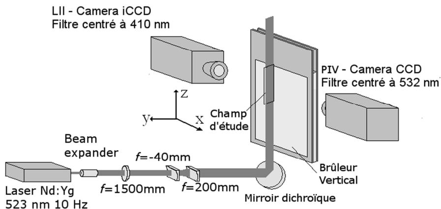
Figure 1 : Montage expérimental LII et PIV simultanés.
