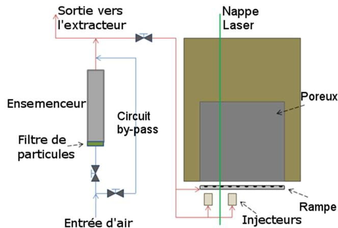
Figure 2 : Système d'ensemencement.
