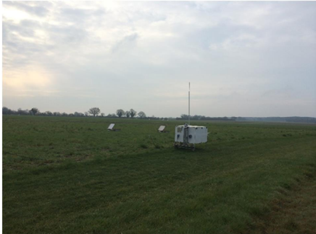
Figure 3.2 : Chambres de mesures GES sur terrain et échantillonnage des sols en printemps 2014
