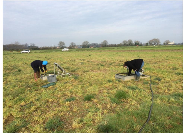
Figure 3.2 : Chambres de mesures GES sur terrain et échantillonnage des sols en printemps 2014
