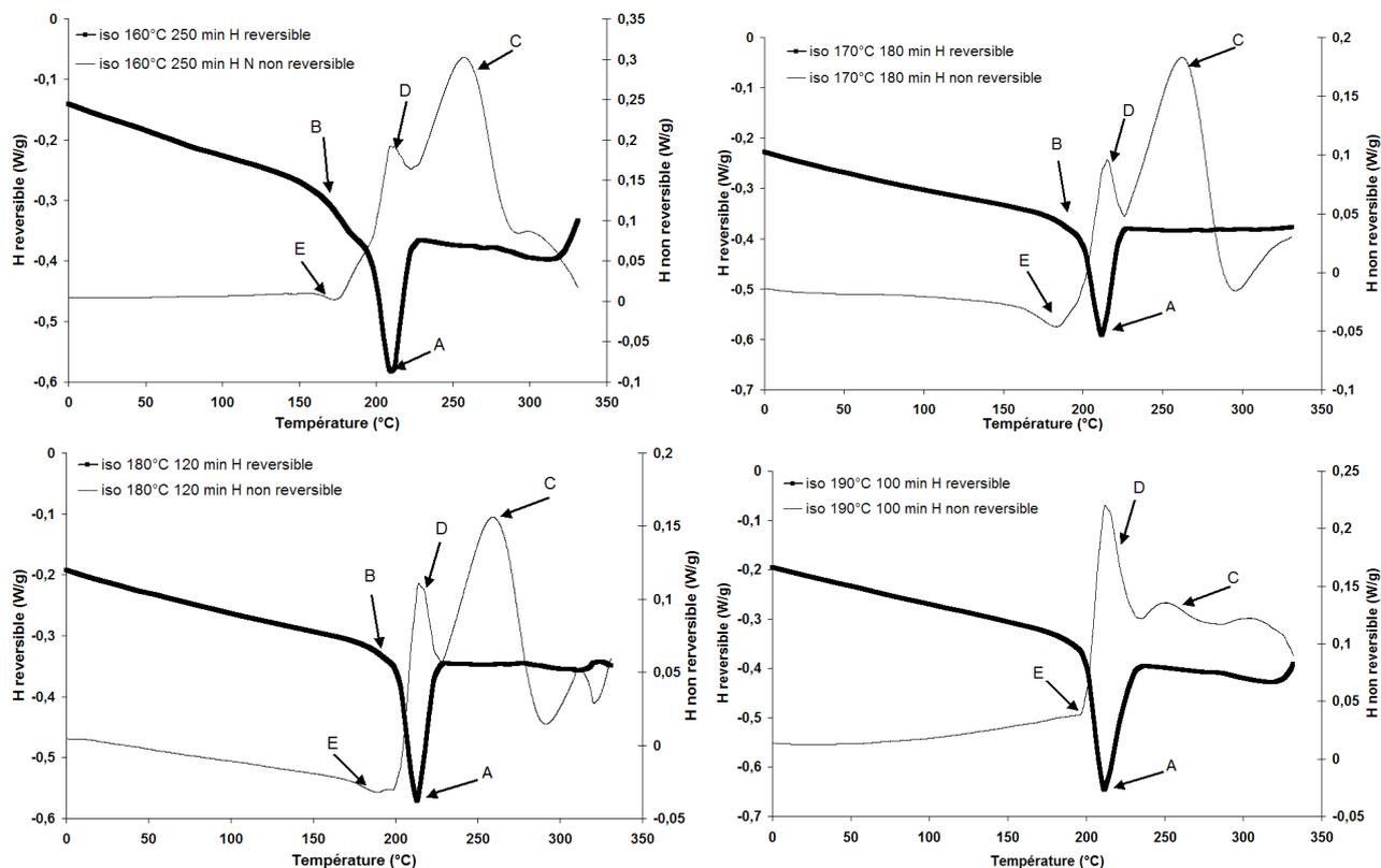
Fig. 3. Balayage résiduel MDSC à 10 °C/min de résine M21 après cuisson isotherme à 160, 170, 180 et 190 °C.
