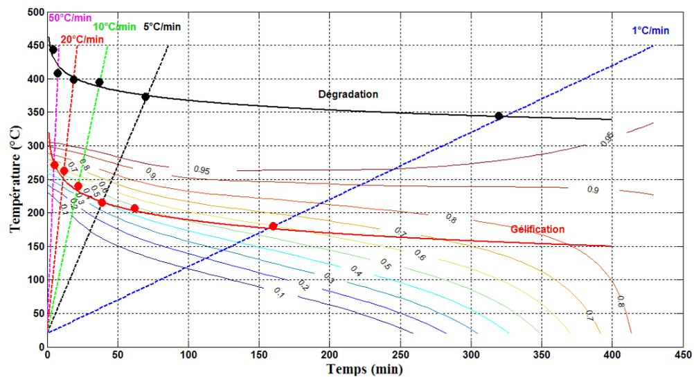
Fig. 7. Diagramme TTT dynamique de la résine M21.
