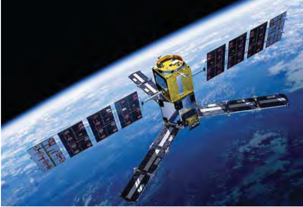
Satellite Smos en orbite, lancé le 2 novembre 2009 par l'Agence spatiale européenne (ASE). C'est le premier satellite mondial d'observation du changement climatique conçu pour suivre la salinité de la mer et surveiller la teneur en eau du sol sur la planète.
