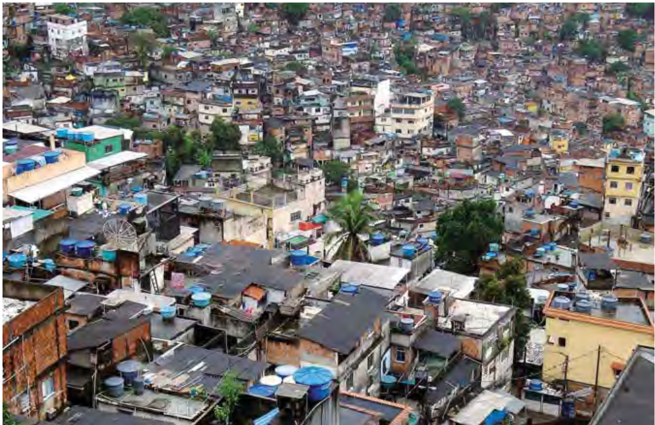
Vue d'une favéla à Rio de Janeiro au Brésil. Les réservoirs qui apparaissent sur les toits sont destinés à stocker de l'eau, car les favélas ne sont pas approvisionnées par les réseaux de distribution d'eau.
