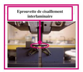
Fig. 6. Montage pour essai de cisaillement interlaminaire.
