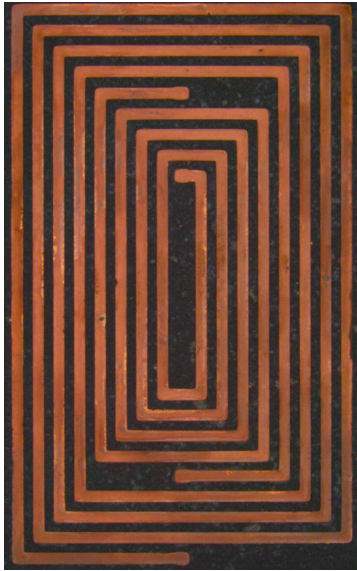
Fig. 2. Transformateur réalisé (Le transformateur a une largeur de 5,24 mm et une longueur de 8,68 mm. L'enroulement extérieur est l'enroulement primaire et l'enroulement intérieur est l'enroulement secondaire.)
