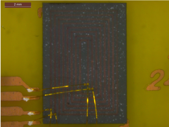
Fig. 3. Transformateur monté sur PCB (ici, un transformateur entrelacé)
