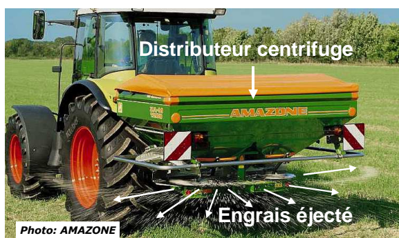
Fig 10 : Photographie d'un distributeur centrifuge attelé à un tracteur (Source : Documentation commerciale Amazone ZA-M.)
