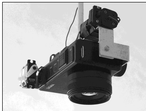
Figure 2 : Exemple de nacelle pour des clichés verticaux ; on distingue à gauche le servo-moteur qui actionne le déclenchement.
