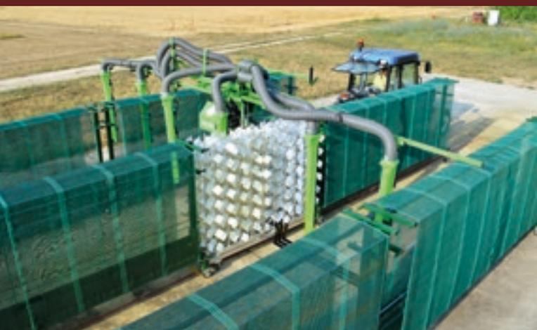
▲ *Test d'un pulvérisateur face par face sur le banc EvaSprayViti*
