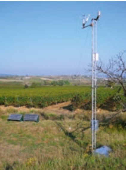
▲ Dispositif de mesure de l'évapotranspiration sur le bassin versant de Roujan © L. Prévot/UMR LISAH
