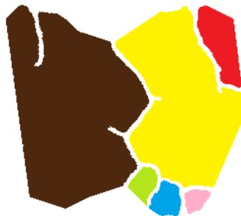
FIGURE 1 – Exemple de particule fragmentée : identification des fragments à partir de l'algorithme de floodfill.
