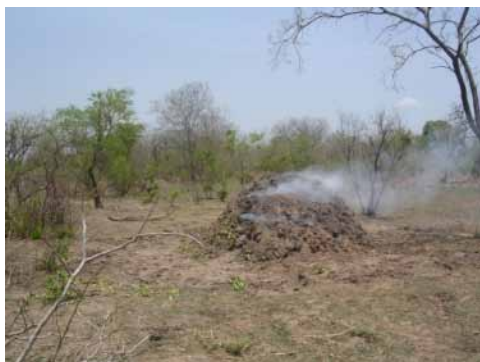
Figure 11. Meule de carbonisation à Dilèka
