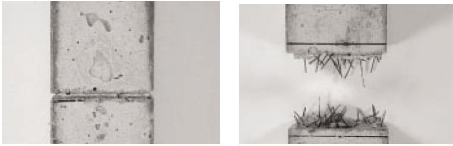
Figure 20. Une éprouvette en béton renforcée de fibres métalliques: (a) avant l'essai de traction ; (b) après rupture
