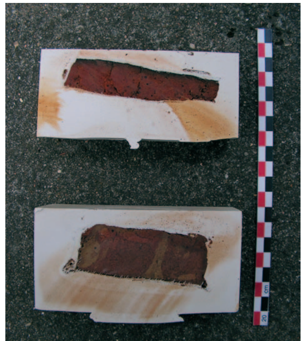
Fig 8 - Vue en coupe de la sole expérimentale (en haut) et de la sole archéologique (en bas)
