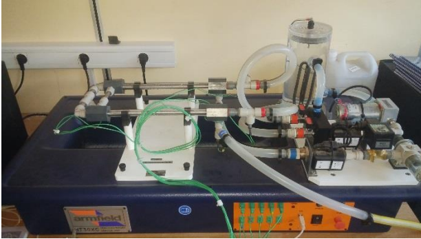
Figure 1 Vue d'ensemble de l'échangeur
