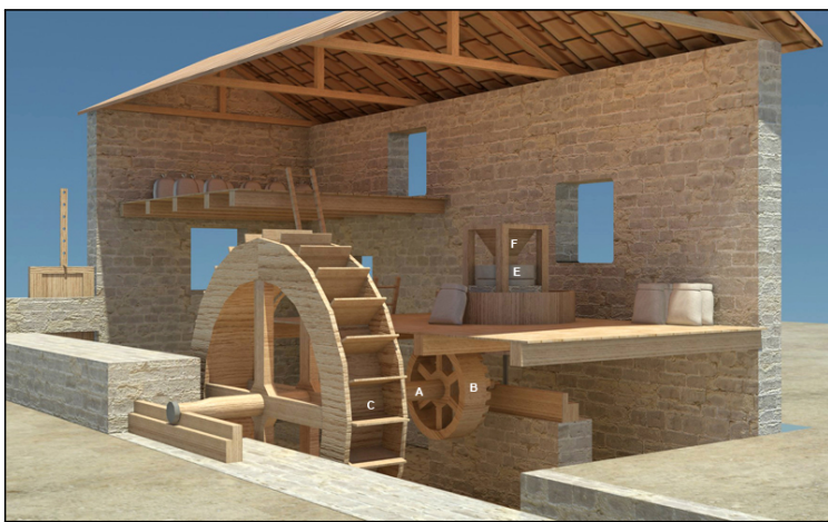
FIGURE 3 – Le moulin à eau décrit par Vitruve, vue éclatée (UCBN – Plan de Rome)
