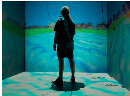
Figure 5 : Dispositif CAVE où l'on voit 4 murs affichant des images stéréoscopiques. L'utilisateur porte des lunettes dont la position et l'orientation 3D sont connues grâce à un système de suivi de mouvement (d'après [28]).
