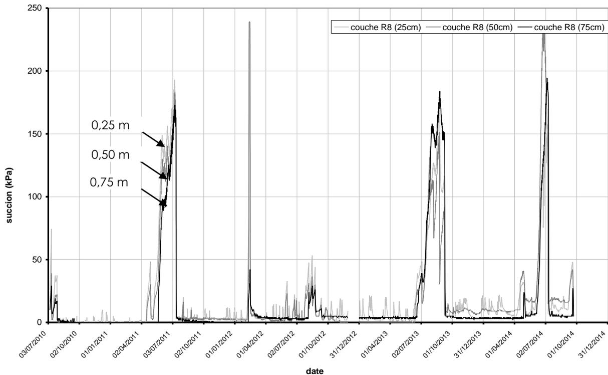
Figure 4. Evolution de la succion de la surface vers la profondeur du talus : 0,25 – 0,50 et 0,75 m de profondeur à mi-hauteur du talus entre 2010 et 2014. les évènements météorologiques ont des effets jusqu'à -0,75 m sous la surface du talus.
