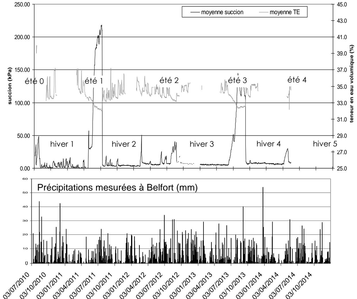
Figure 6. Évolution de la teneur et de la succion à 0,25 m de profondeur (couche R5) sur le limon traité à 2% de chaux vive, ainsi que de la pluviométrie enregistrée à Belfort, à 9 km du site, entre 2010 et 2014.
