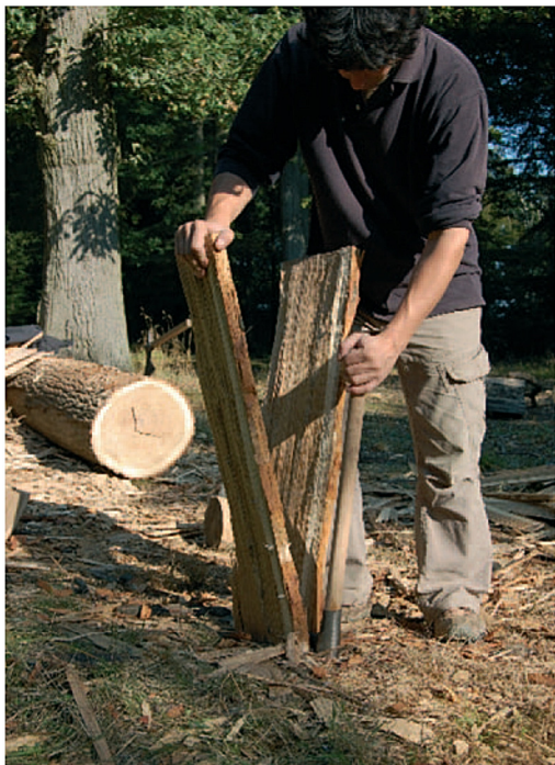
Fig. 36 - Fendage des bardeaux en chêne au départoir.
