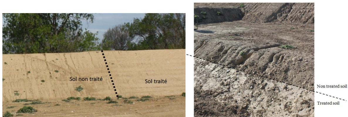
Figure 4 : vue du démonstrateur avant l'essai de surverse, 18 mois après la construction
