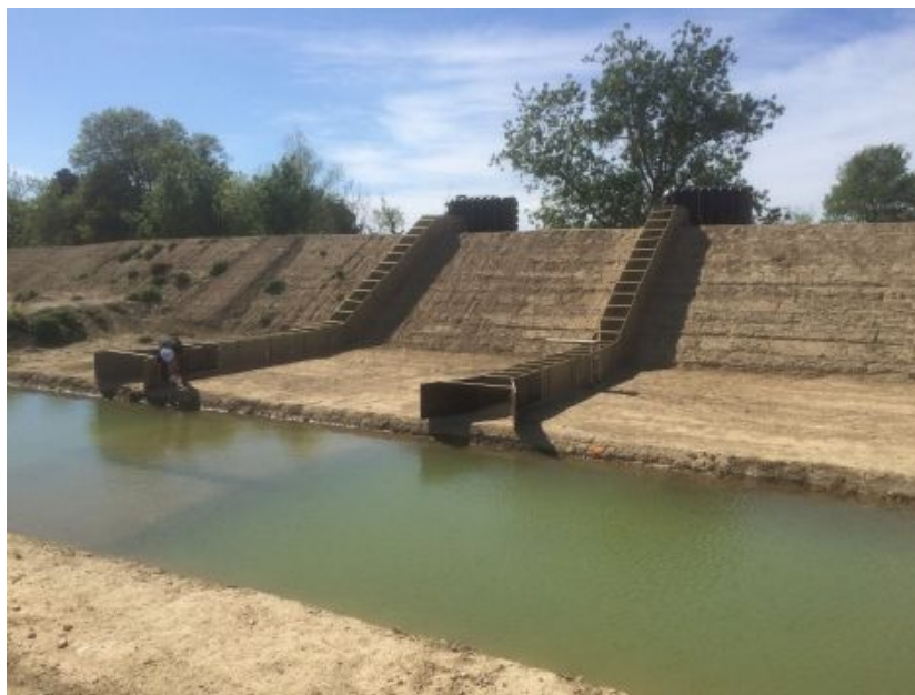
Figure 1 : Le démonstrateur DigueElite, avec les 2 canaux avant essai, sol non traité à gauche, sol-chaux à droite.
