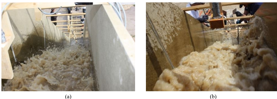
Figure 4 : Vue de l'écoulement en tête de talus et en cours d'essai pour un débit de 95 l/s/mL (a) et un débit de 570 l/s/mL (b) ; les parois latérales font 60 cm de haut.
