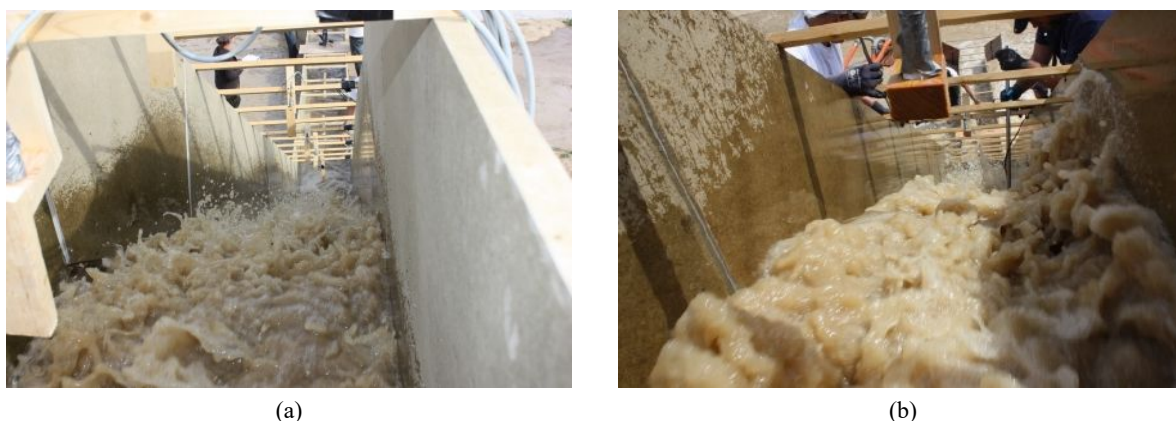
Figure 4 : Vue de l'écoulement en tête de talus et en cours d'essai pour un débit de 95 l/s/mL (a) et un débit de 570 l/s/mL (b) ; les parois latérales font 60 cm de haut.
