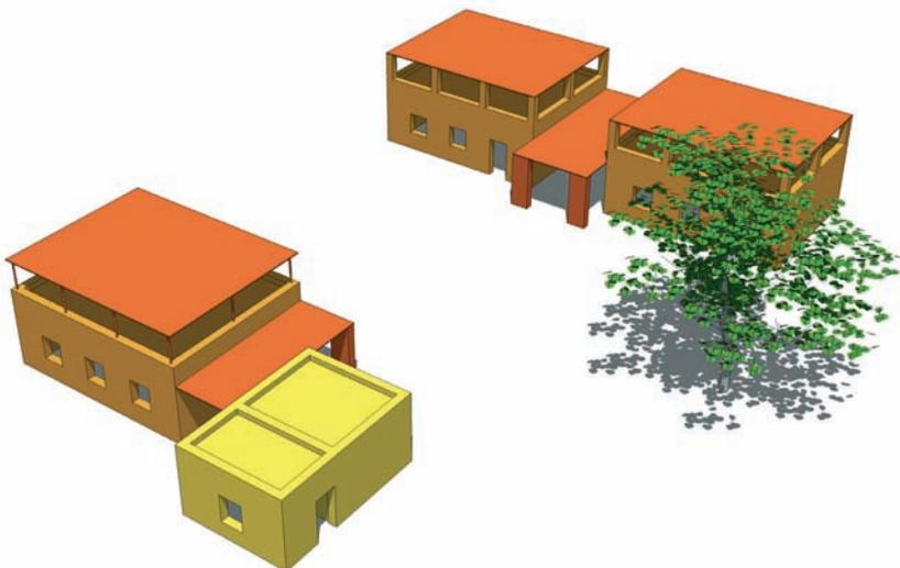
Les bâtiments sont répartis en deux blocs de deux pièces. La disposition des blocs forme une cour. Les salles de classe sont surmontées de sur-toitures ventilées qui garantissent moins de surchauffe par le toit. Ces terrasses ombragées peuvent être utilisées. Les pièces sont elles-mêmes séparées par des lieux couverts, ombragés et ventilés assez larges pour servir d'espaces de jeux ou d'activités scolaires.
