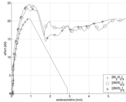
**Figure 3.** Courbes effort / extensomètre pour les stratifiés orthotropes (90/0)
